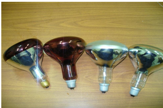
Рис. 1. Вид излучателей направленного ИК излучения - электролампы: 250 / IR/ R / E27; ИКЗК-250; ИКЗ-250М; ИКЗ-250 (слева направо)
